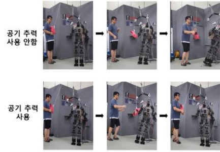
[그림 3] 공기 추력을 이용한 넘어짐 방지 실험
