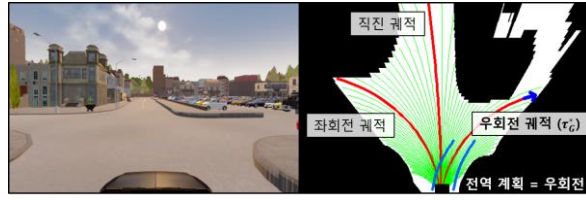
Fig. 3 십자형 교차로에서의 [직진, 좌회전, 우회전]로 구분된 목표 궤적. 전역 계획이 우회전임에 따라, 추종하게 될 우회전 궤적( \tau_G^* ).
